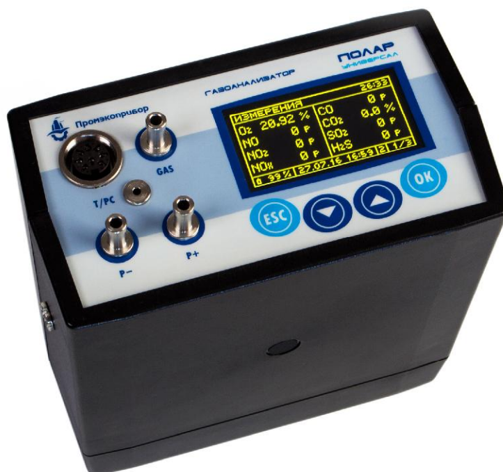
Рисунок 5 - Внешний вид газоанализаторов модели «Полар Универсал»
