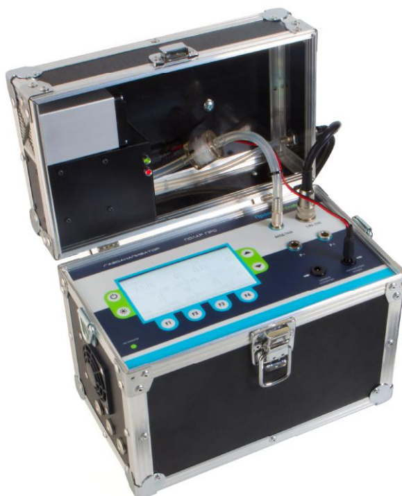
Рисунок 7 - Внешний вид газоанализаторов модели «Полар про»
