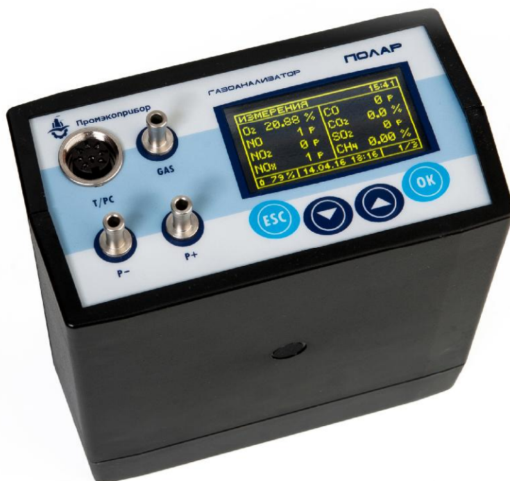
Рисунок 1 - Внешний вид газоанализаторов модели «Полар»
