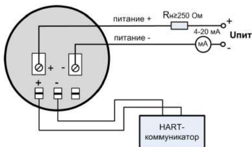
Рисунок В.8 – Подключение HART-коммуникатора с временно устанавливаемым на его входе дополнительным резистором нагрузки (R) сопротивлением 250 Ом
