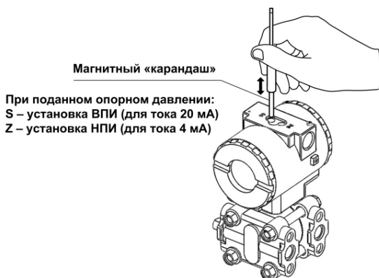
Рисунок 6.1 – Расположение местных регуляторов настройки, отверстие установки нуля обозначено Z (Zero), диапазона – S (Span)
