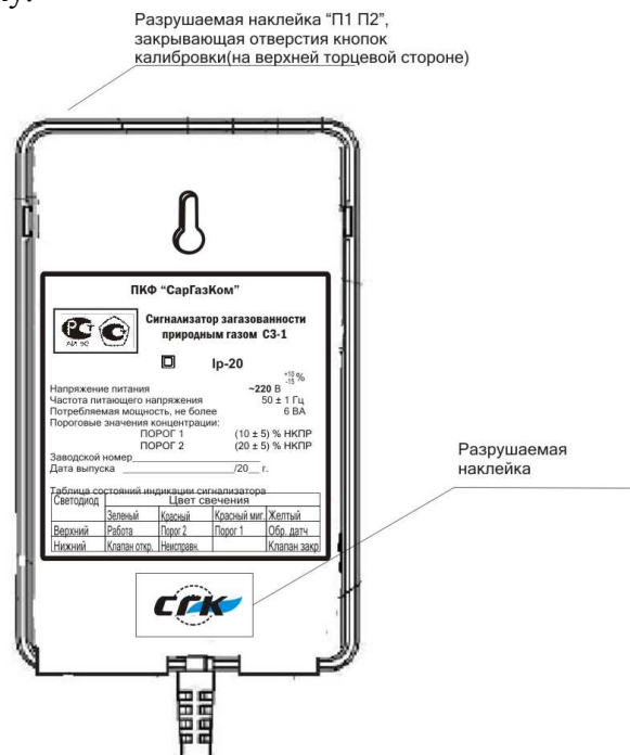
Фото 2 - Схема пломбировки сигнализатора от несанкционированного доступа и обозначение мест для нанесения наклеек с клеймом поверителя
