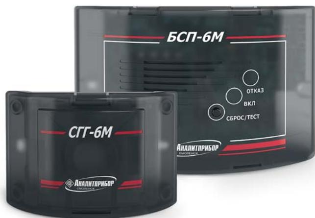
Предназначен для непрерывного автоматического контроля содержания природного и сжиженного газов; выдачи световой и звуковой сигнализации в случае возникновения в помещении довзрывоопасных концентраций газов; перекрытия газопровода быстродействующим электромагнитным клапаном.
