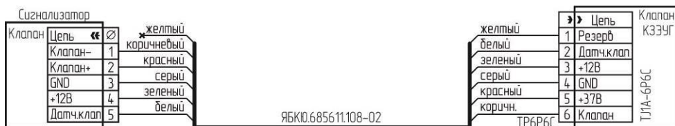
Рисунок Г.8 – Схема подключения клапана КЗЭУГ с разъемом TJA-6P6C
