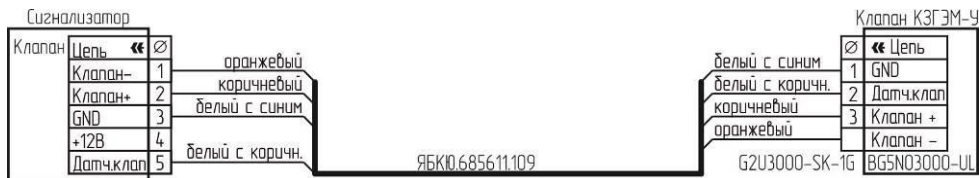
Рисунок Г.6 – Схема подключения клапана КЗГЭМ-У с разъемом BG5N03000-UL.
