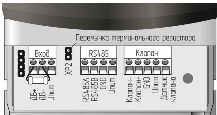
Рисунок В.2 – Расположение разъемов сигнализатора СЗ-2Е-485(Р).
