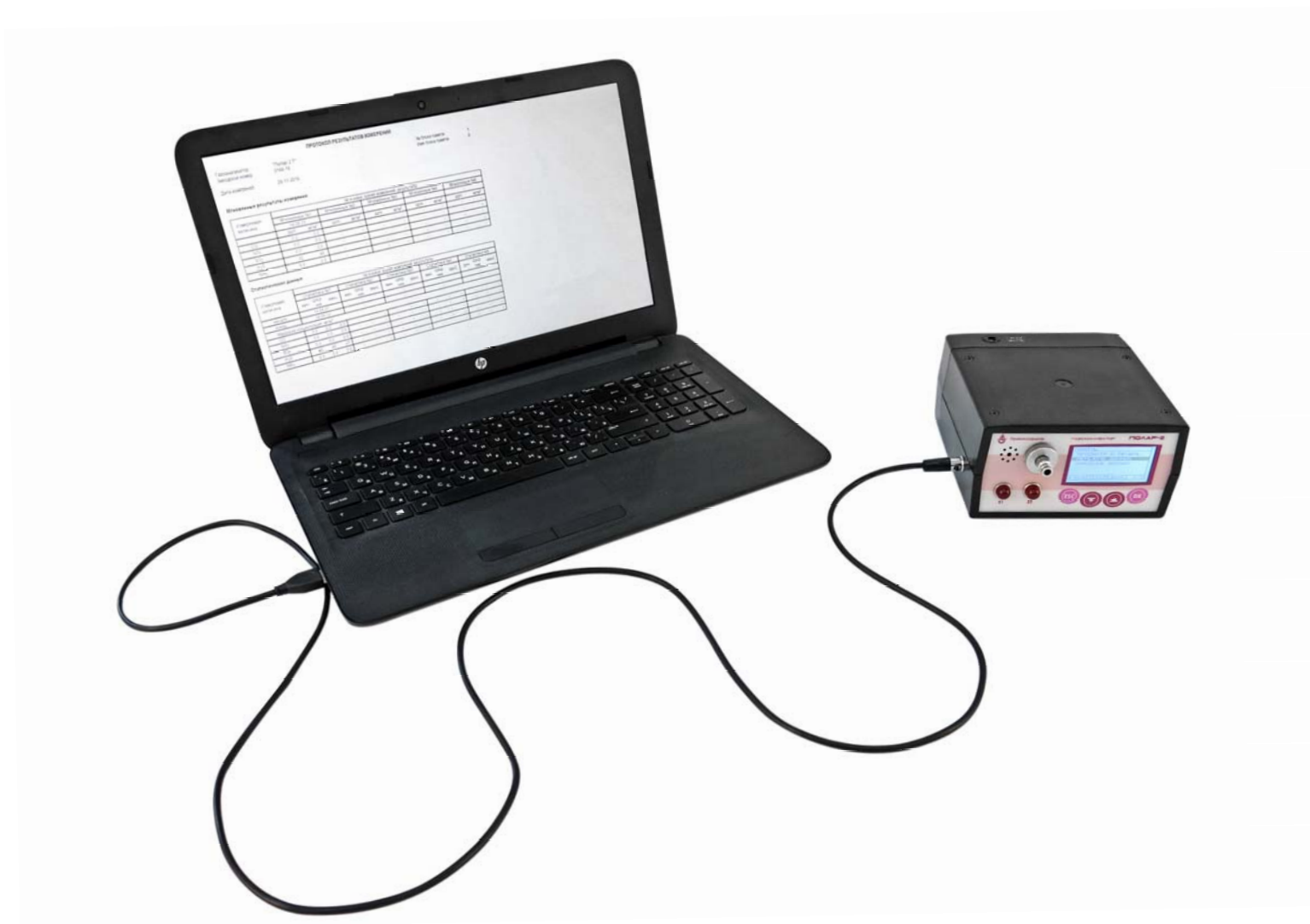
Рисунок 17 – Подключение газоанализатора к персональному компьютеру
