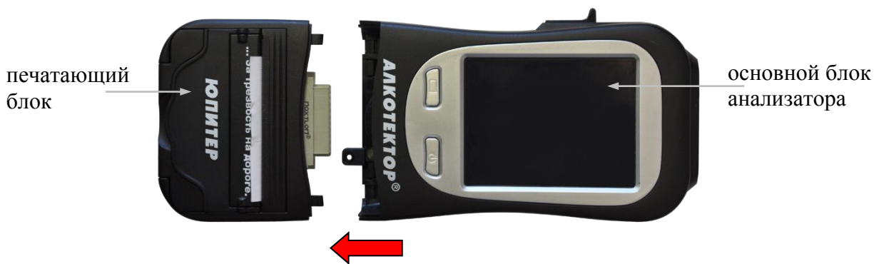
Рисунок 31 – Отсоединение печатающего блока
