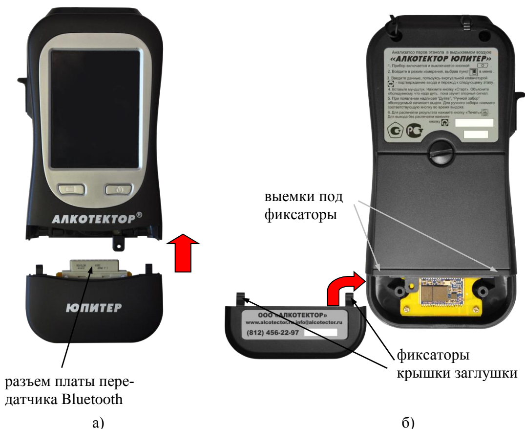
Рисунок 32 – Подсоединение заглушки к основному блоку анализатора
