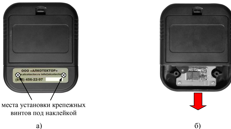
Рисунок 29 – Отсоединение заглушки от приемника Bluetooth
