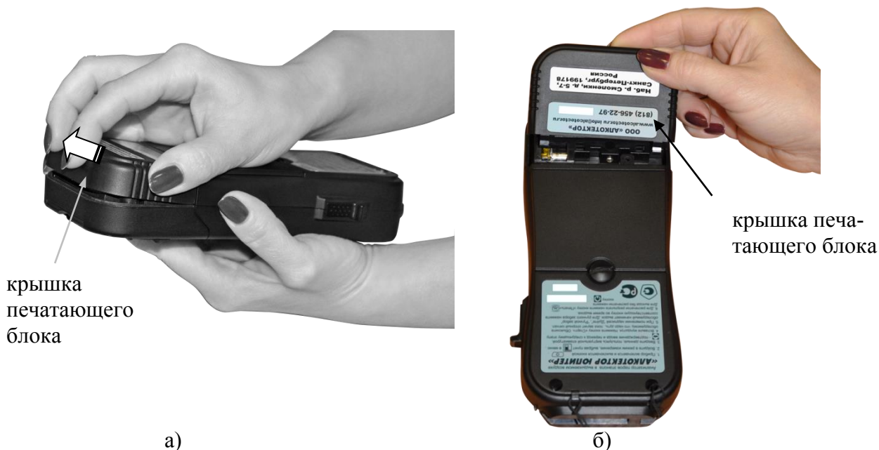
Рисунок 30 – Отсоединение крышки печатающего блока
