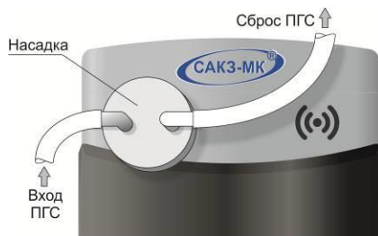
Рисунок Г.1 – Установка насадки для подачи ПГС
