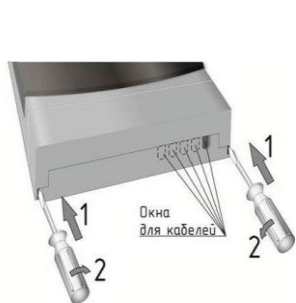
Рисунок 2 – Снятие крышки клеммного отсека
