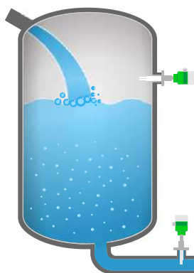
Рисунок. 2.2 - Монтаж сигнализатора в зоне струи наполнения
